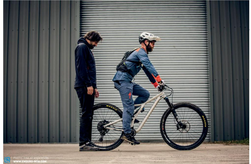
1. *Federt energisch ein und wieder aus, um die Negativluftkammer zu füllen und den Federweg freizugeben.*
