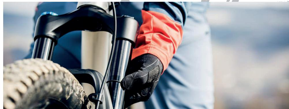
1. *Federt energisch ein und wieder aus, um die Negativluftkammer zu befüllen und die Dichtungen zu lösen.*
